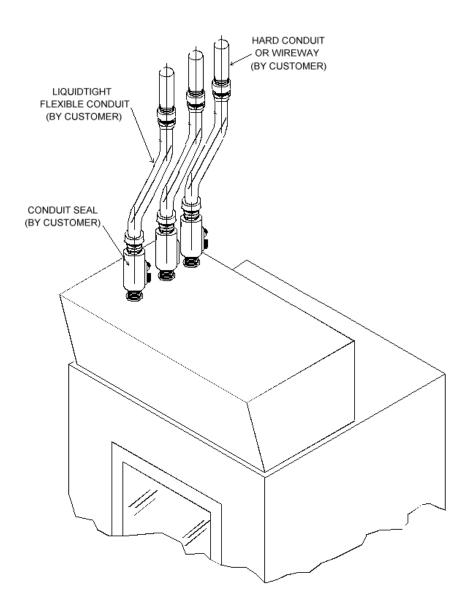
Figure 4.5: Conduit and Conduit Seals
